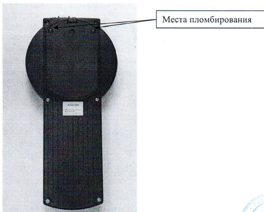
Рисунок 2 - Схема пломбировки от несанкционированного доступа
