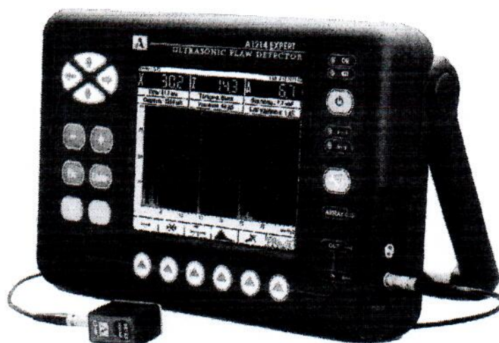
Рисунок 2 – Общий вид дефектоскопа ультразвукового A1214 EXPERT На рисунках 3 и 4 показаны места пломбировки корпуса дефектоскопа для предотвращения несанкционированного доступа и место нанесения знака утверждения типа.
