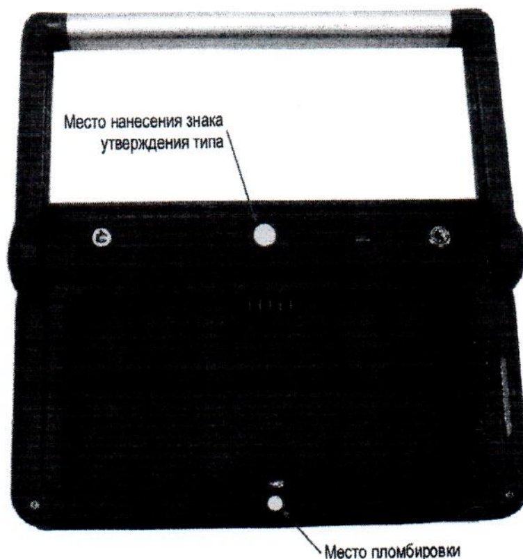
Рисунок 4 – Место пломбировки корпуса дефектоскопа A1214 EXPERT (аккумулятор снят, ручка поднята) и место знака утверждения типа
