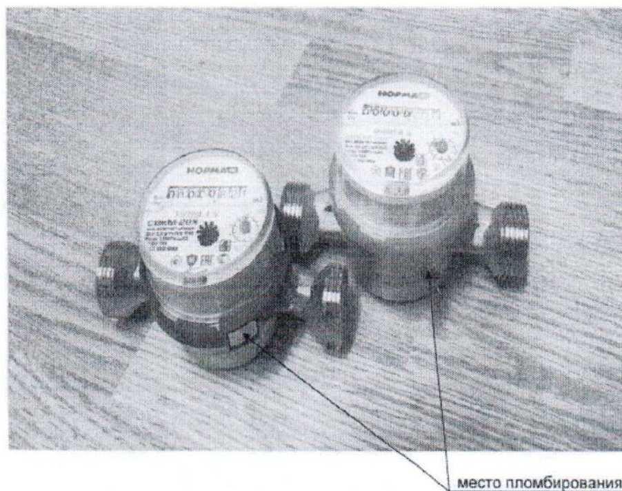
Рисунок 2 – Общий вид счетчиков СВКМ DN 15, имеющих специальное крепление счётного механизма к корпусу без кольца (снятие крышки невозможно без ее механического повреждения)
