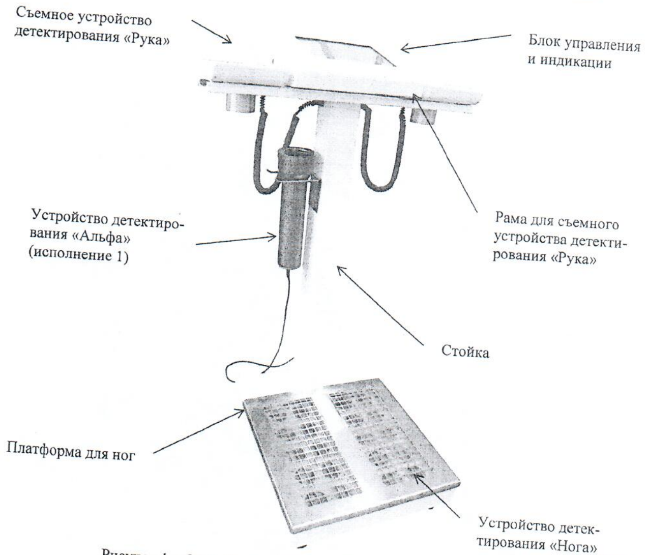
Рисунок 1 – Общий вид установки МКС-100А «Чистотел»
