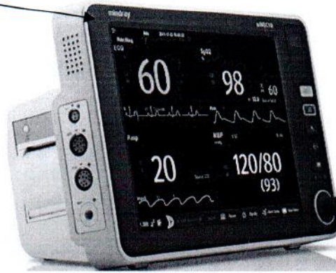
Рисунок 2.1 – Схема (рисунок) с указанием места для нанесения знака поверки на монитор uMEC10
