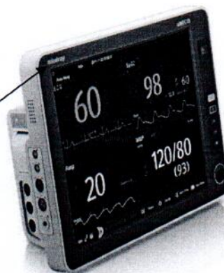
Рисунок 2.3 –Схема (рисунок) с указанием места для нанесения знака поверки на монитор uMEC15
