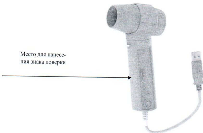
Рисунок 2.3 – Схема (рисунок) с указанием места для нанесения знака поверки на спирометр MAC2-ПКМ
