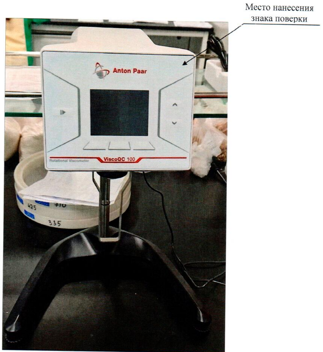
Рисунок 2.1 – Место нанесения знака поверки в виде клейма-наклейки
