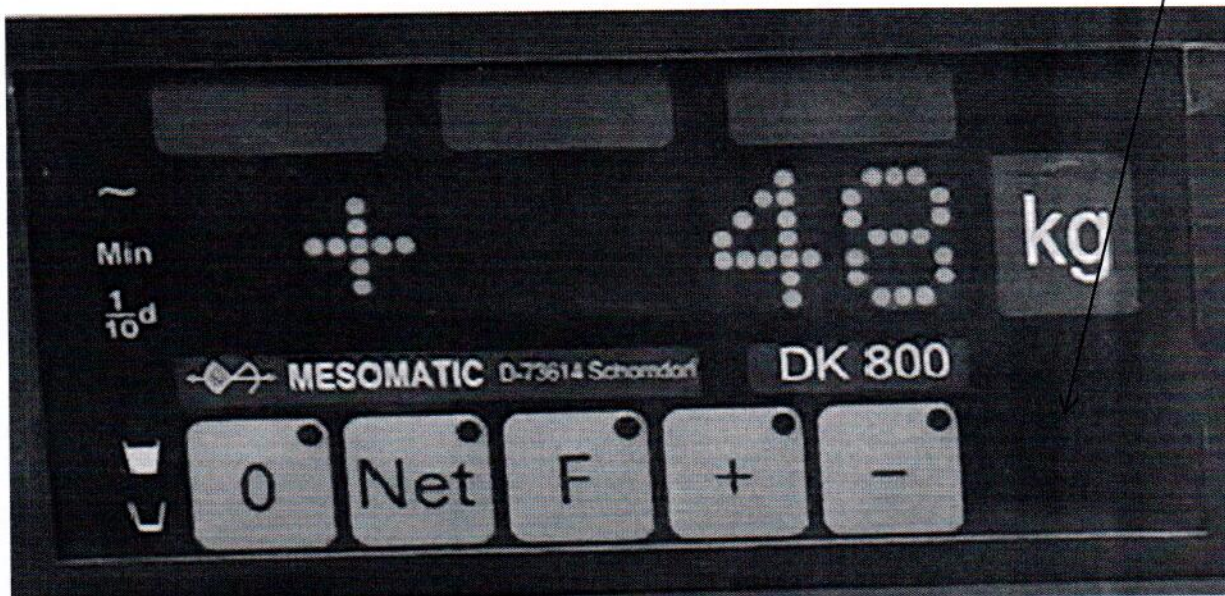
Рисунок 2.1 - Фотография с указанием места нанесения знака поверки (наклейки) на лицевую панель преобразователя весоизмерительного Mesomatic DK800.
