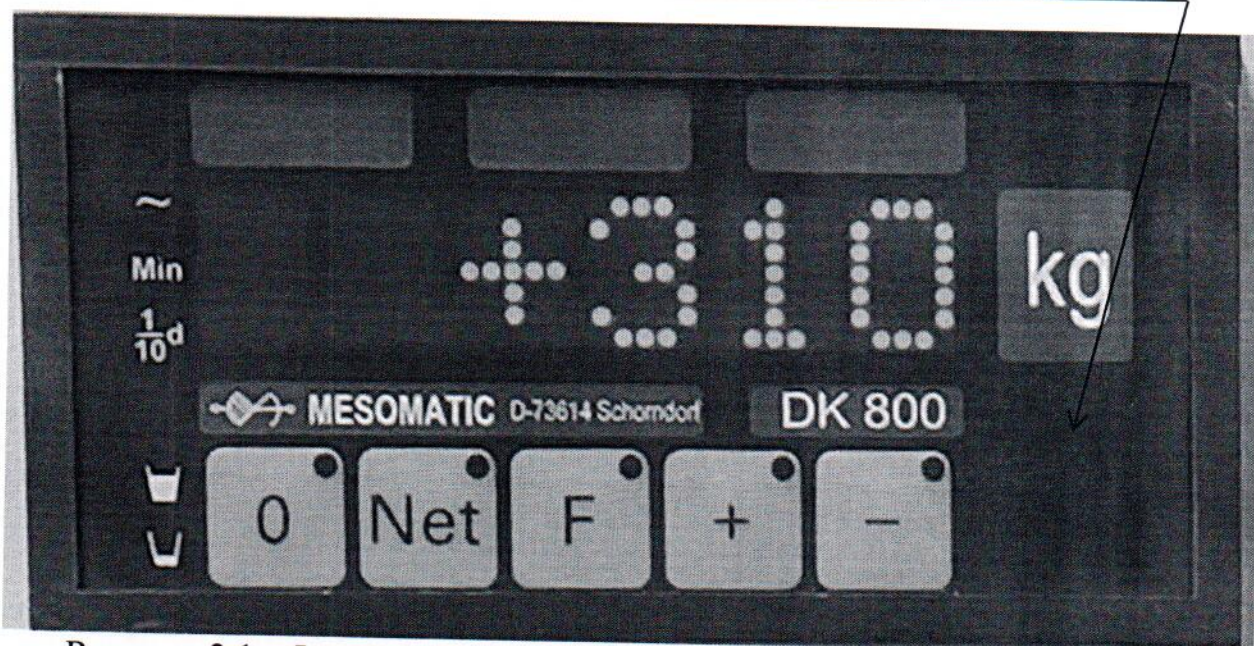
Рисунок 2.1 - Фотография с указанием места нанесения знака поверки (наклейки) на лицевую панель преобразователя весоизмерительного Mesomatic DK800.
