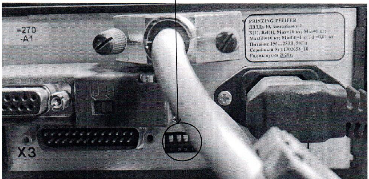
Рисунок 2.2 - Фотография с указанием места нанесения знака поверки (наклейки) на заднюю панель преобразователя весоизмерительного Mesomatic DK800.
