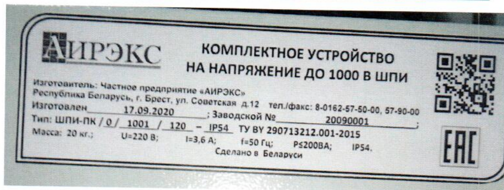
Комплектное устройство на напряжение до 1000 В ШПИ (УСПД)
