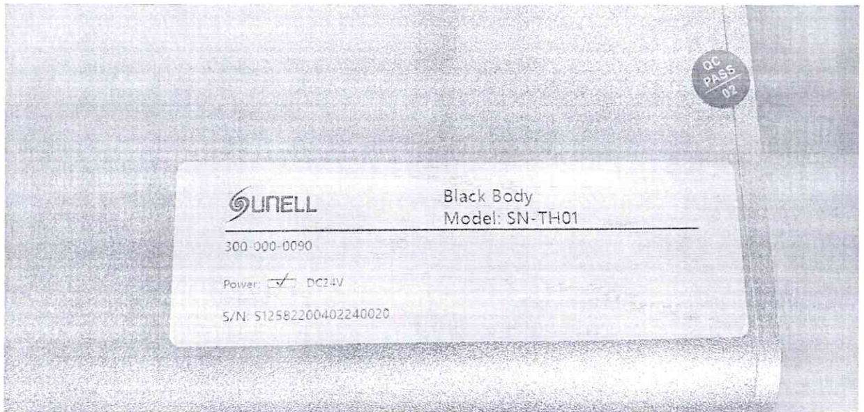
Рисунок 2 – Маркировка абсолютно черного тела Sunell SN-TH01 № S12582200402240020
