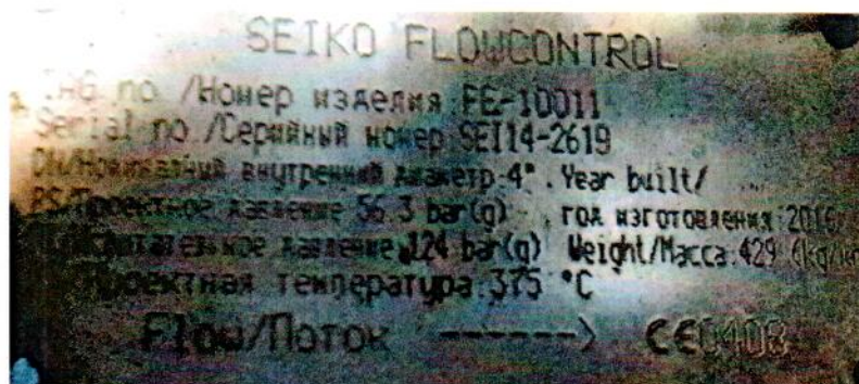
Рисунок А.3 – Маркировка клинового расходомера SEIKO № FE-10011
