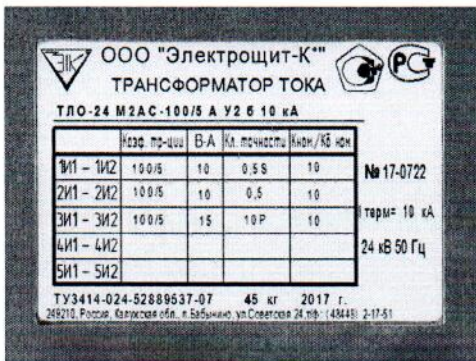
Рисунок 3 – Место нанесения паспортной таблички и знака утверждения типа
