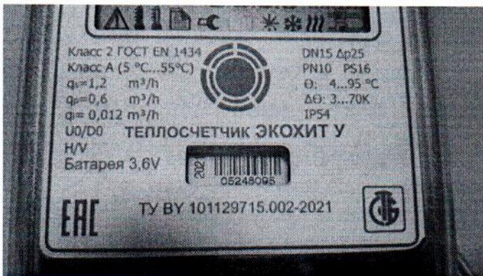
Рисунок 1.2 Общий вид теплосчетчиков модификаций Экохит У
