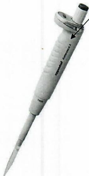
Рисунок Б.1 - Место нанесения знака поверки в виде клейма-наклейки
