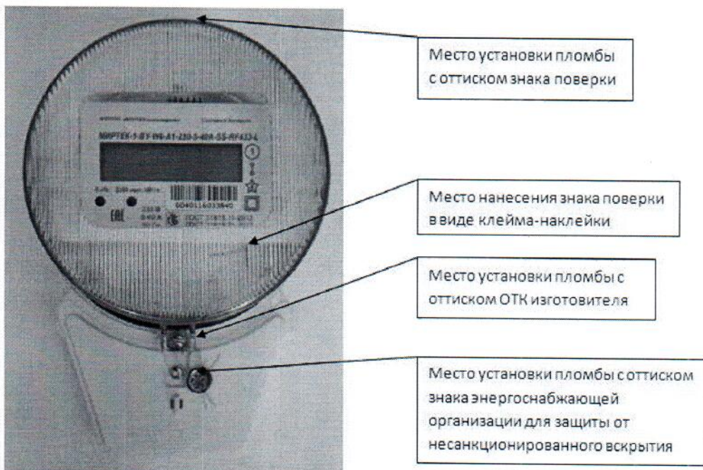
Рисунок Б.6 – Места установки пломб и нанесения знака поверки для счетчиков в корпусе W6
