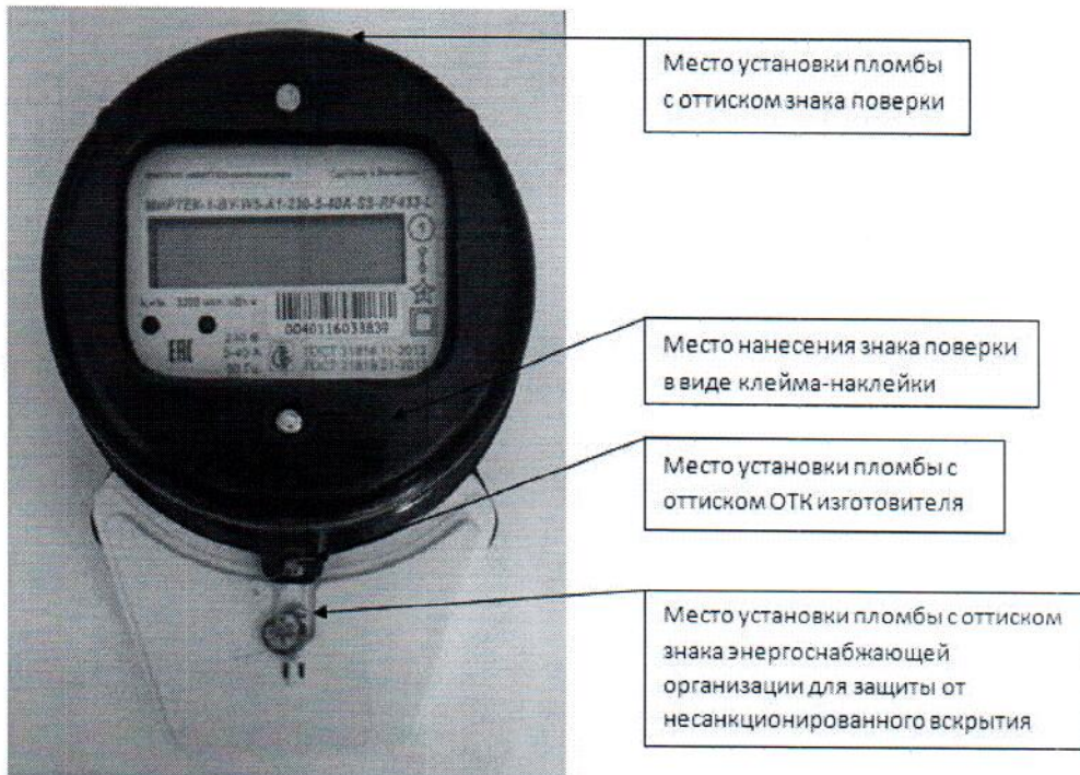
Рисунок Б.5 – Места установки пломб и нанесения знака поверки для счетчиков в корпусе W5
