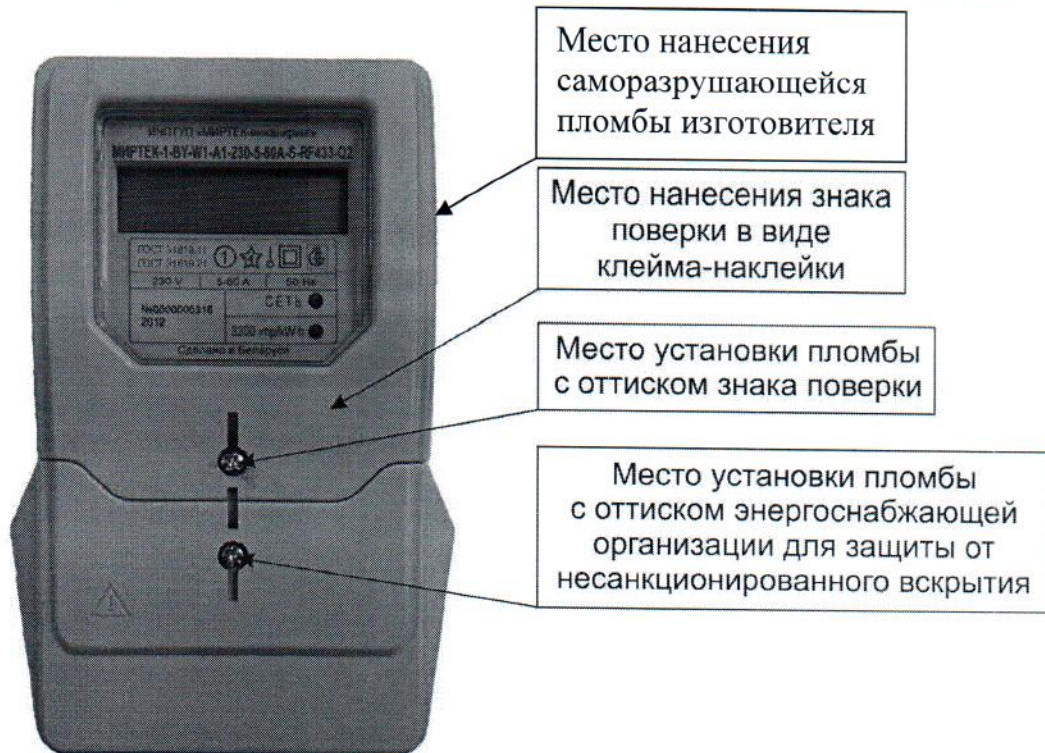
Рисунок Б.1 – Места установки пломб и нанесения знака поверки для счетчиков в корпусе W1
