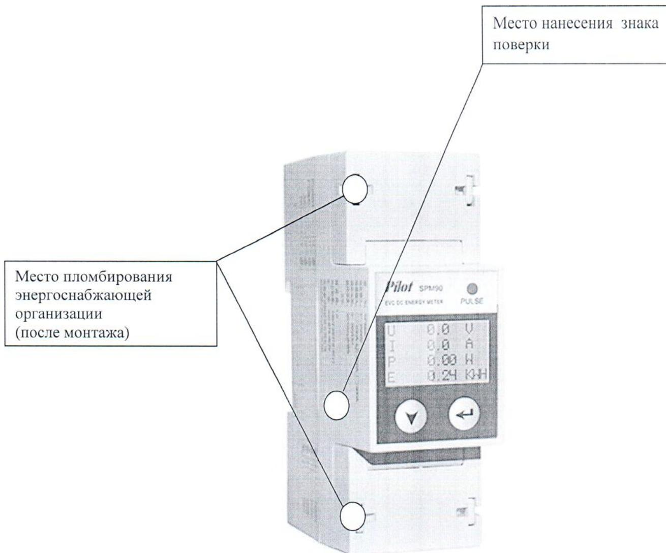
Рисунок 2.1 – Схема (рисунок) с указанием места для нанесения знака(ов) поверки средств измерений и пломбировки от несанкционированного доступа счетчика SPM90 зав. № SPM90-2-2009224590
