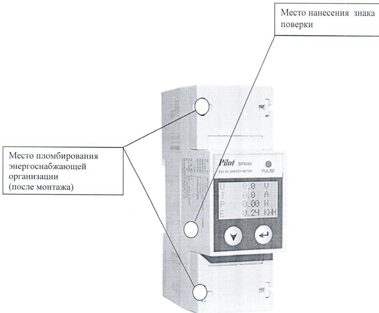
Рисунок 2.1 – Схема (рисунок) с указанием места для нанесения знака(ов) поверки средств измерений и пломбировки от несанкционированного доступа счетчика SPM90 зав. № SPM90-2-2009224566
