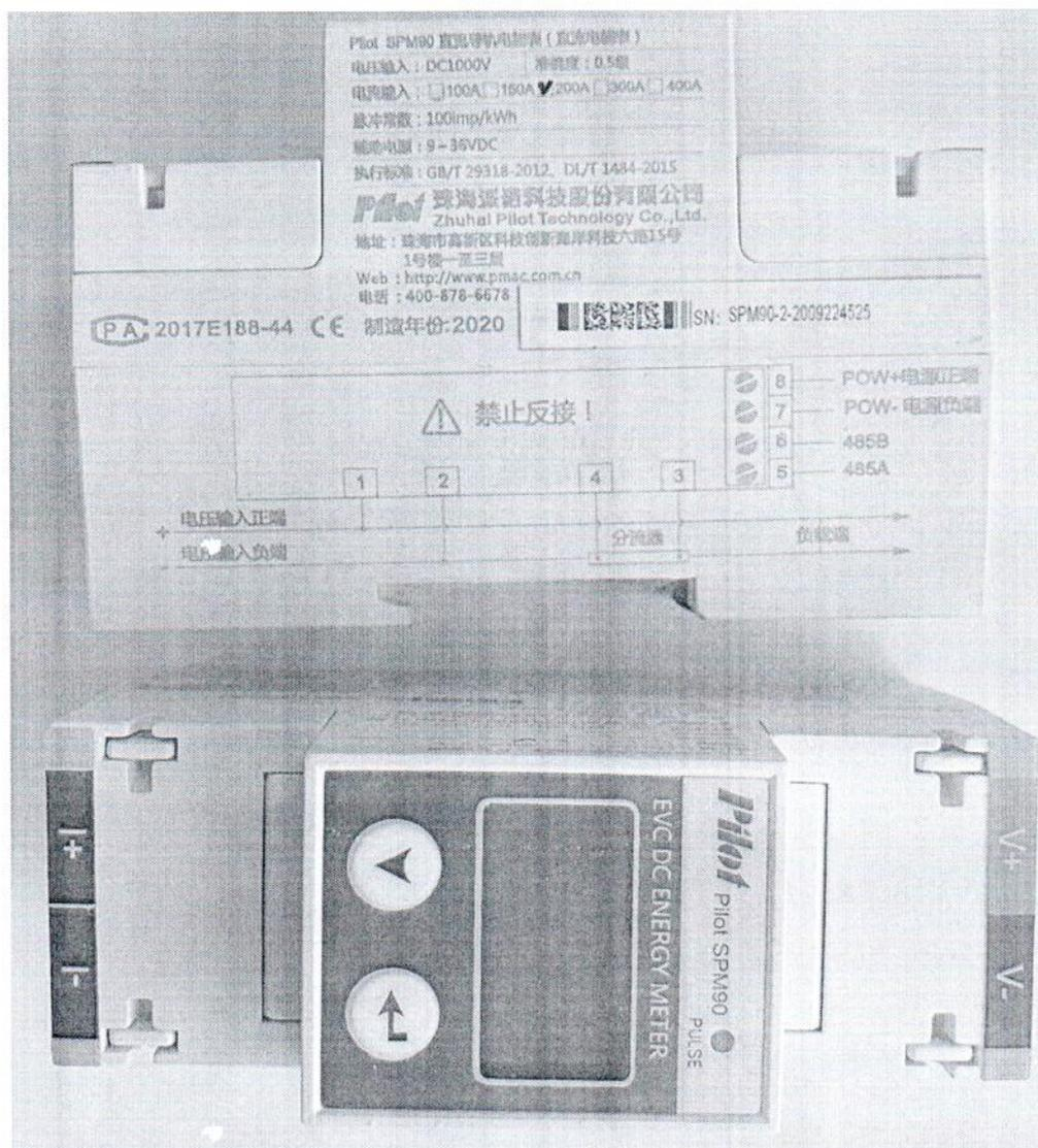
Рисунок 1.1 – Внешний вид счетчика SPM90 зав. № SPM90-2-2009224525
