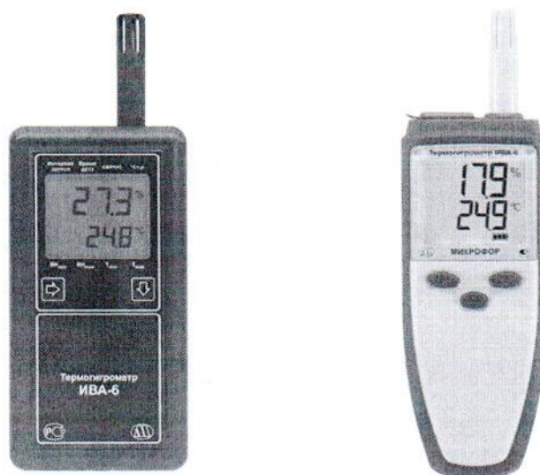
Рисунок 1 – Общий вид термогигрометров ИВА-6Н
