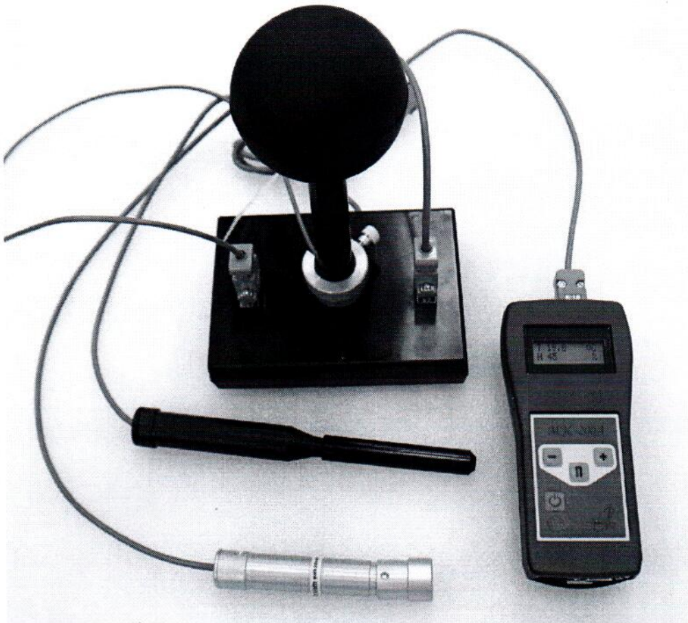
Рисунок 1 – Внешний вид прибора контроля параметров воздушной среды «Метеометр МЭС-200А»
