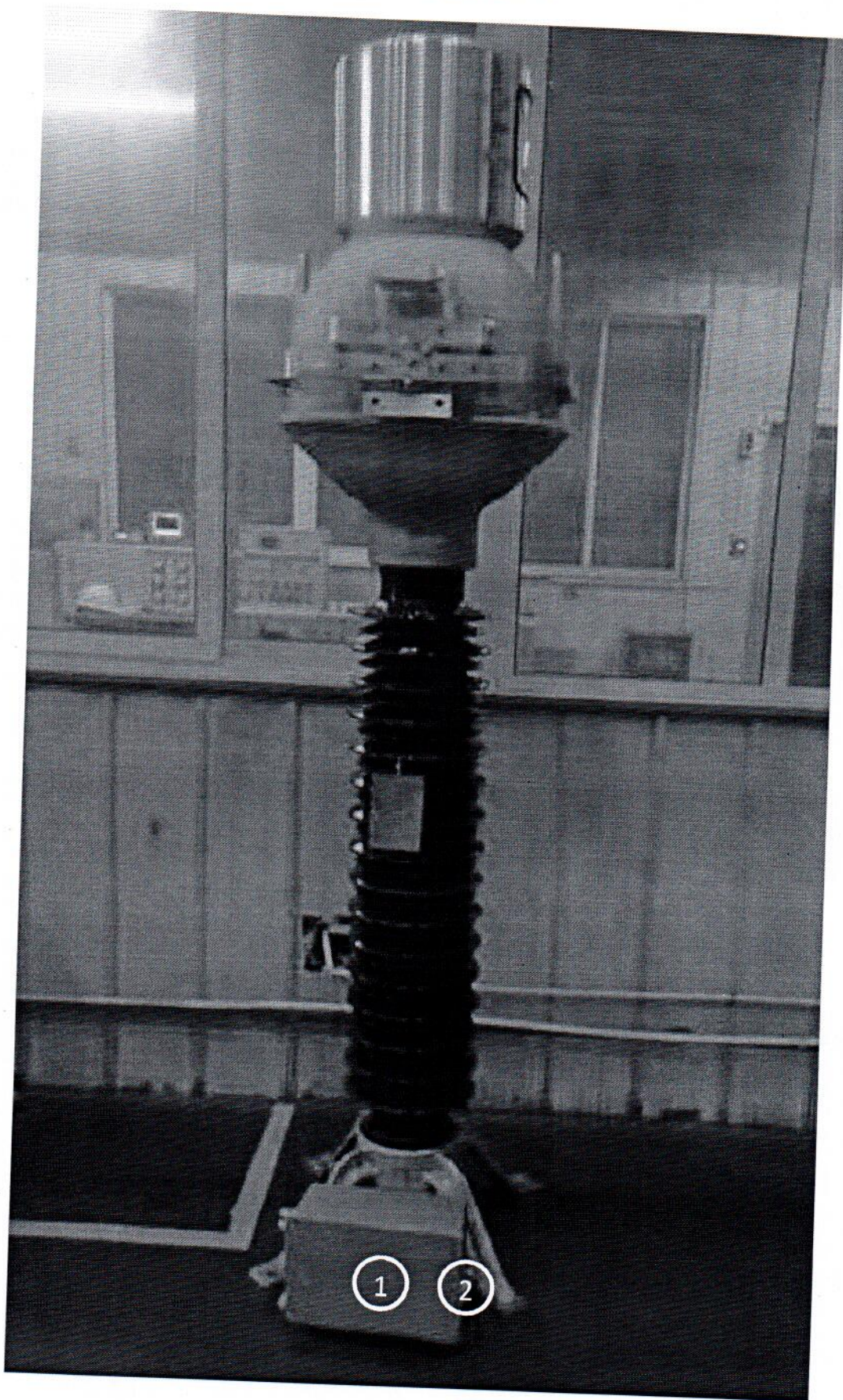
Рисунок 1 - Фотография общего вида со схемой нанесения знака поверки и места пломбировки 1 - место нанесения знака поверки, 2 - место пломбировки от несанкционированного доступа
