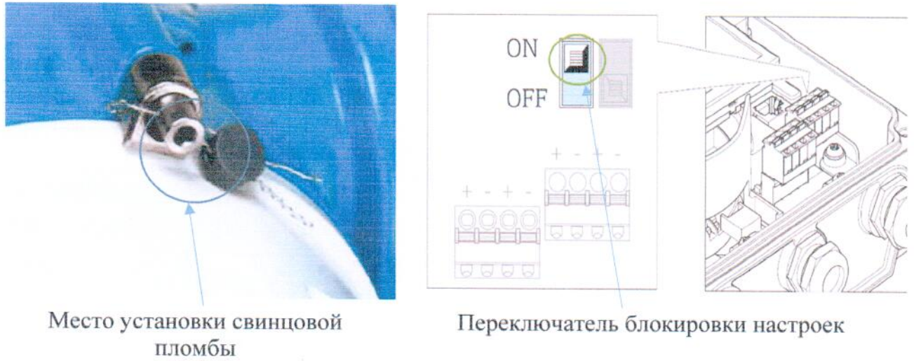
Рисунок 1 – Схема пломбировки от несанкционированного доступа
