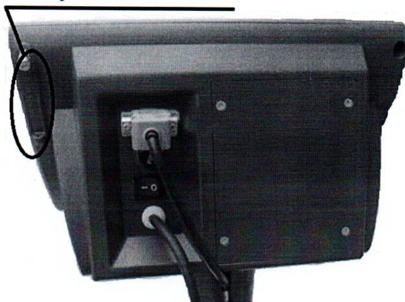
Рисунок 2.1 – Схема пломбировки весов от несанкционированного доступа с указанием мест нанесения знака поверки в виде клейма-наклейки и оттиска поверительного клейма показывающего устройства А12.
