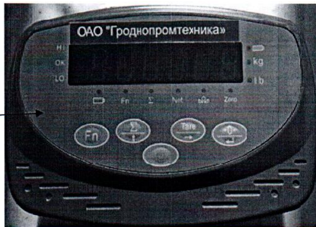
Рисунок 2.2 - Место расположения знака поверки на весах (терминал – вид спереди)
