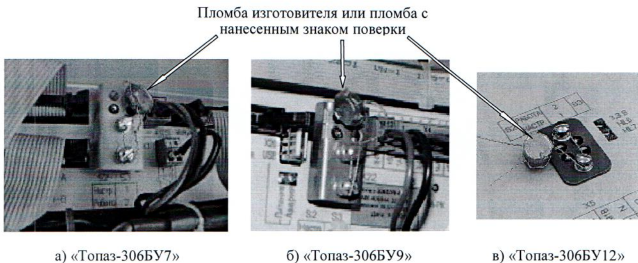
Рисунок 12 – Схемы пломбировки блоков управления «Топаз-306БУ7», «Топаз-306БУ9» и «Топаз-306БУ12»
