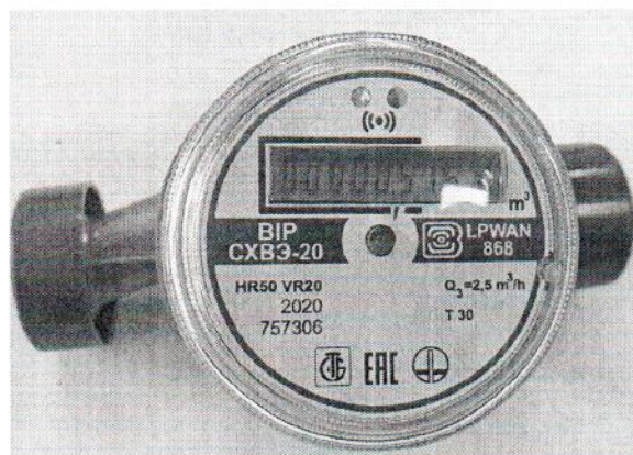
Рисунок А3 – Общий вид маркировки счетчиков DN 20 с радиомодулем LPWAN 868 радиоканала счетчика в экспортном исполнении в соответствии с требованиями ГОСТ ISO 4064
