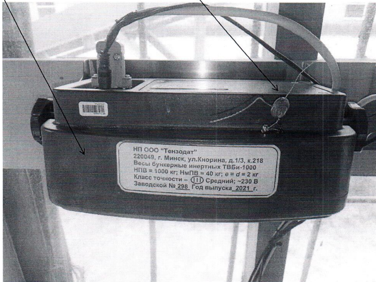
Рисунок Б.1 - Схема с указанием места нанесения знака поверки, место и схема пломбировки от несанкционированного доступа
