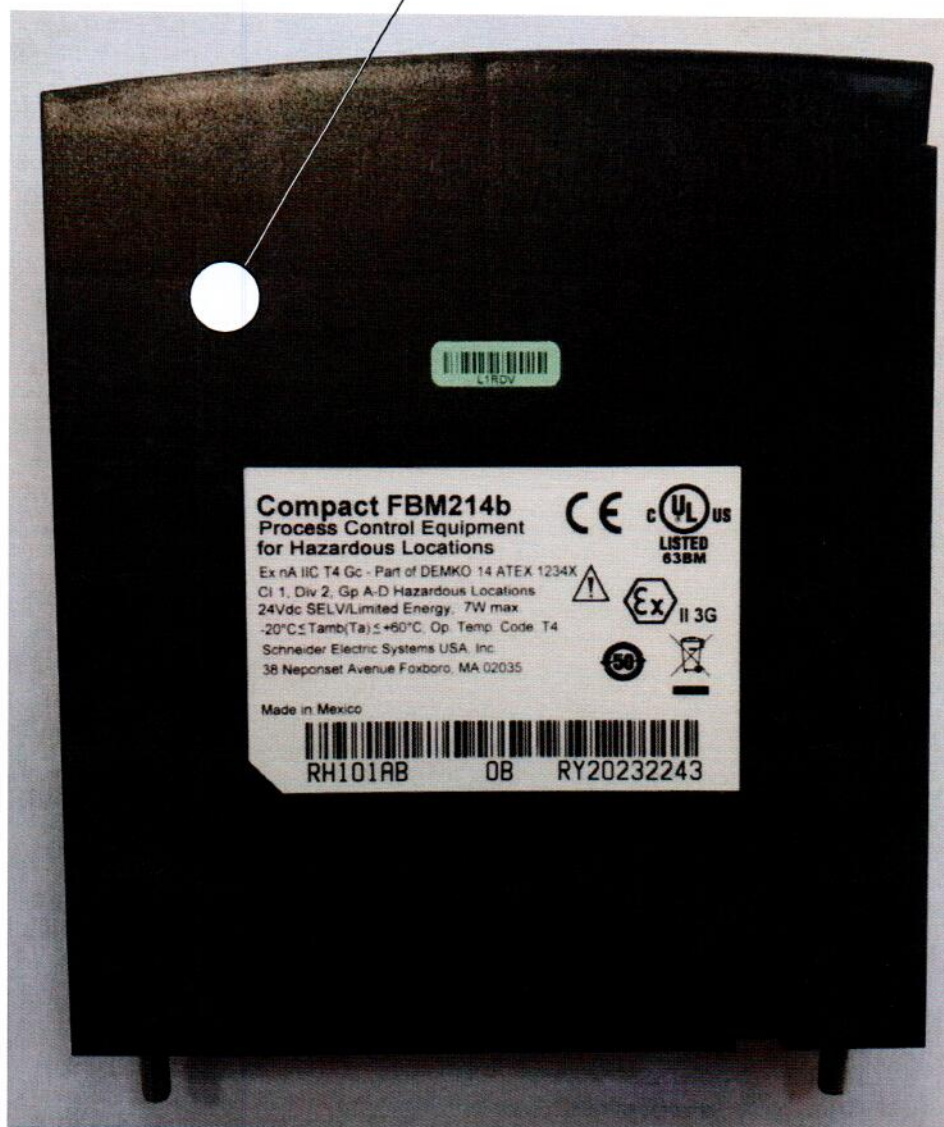
Рисунок Б.1 – Место нанесения знака поверки в виде клейма-наклейки на измерительном модуле Compact FBM
