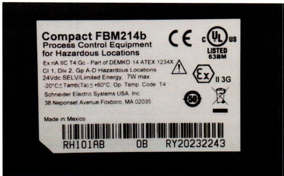
Рисунок А.4 – Образец маркировки измерительного модуля Compact FBM
