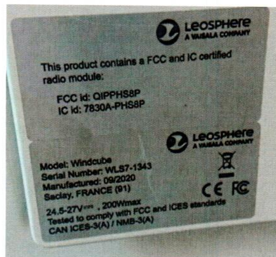
Рисунок А.2 – Маркировка прибора для измерения параметров ветра типа лидар WindCube Vertical Profiler, зав. № WLS7-1343
