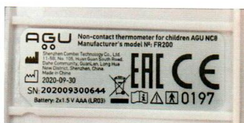
Рисунок А.2– Пример маркировки термометров
