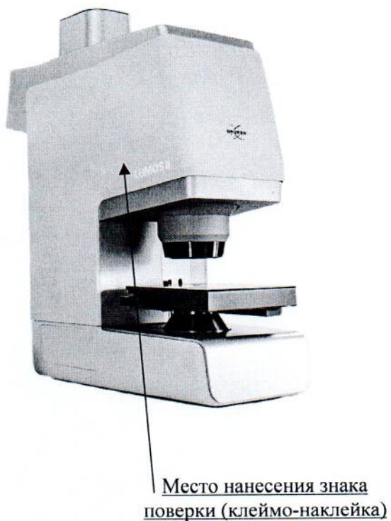
Рисунок Б.1 - Место нанесения знака поверки в виде клейма-наклейки
