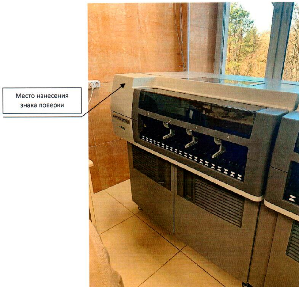
Рисунок Б.1 - Место нанесения знака поверки в виде клейма-наклейки
