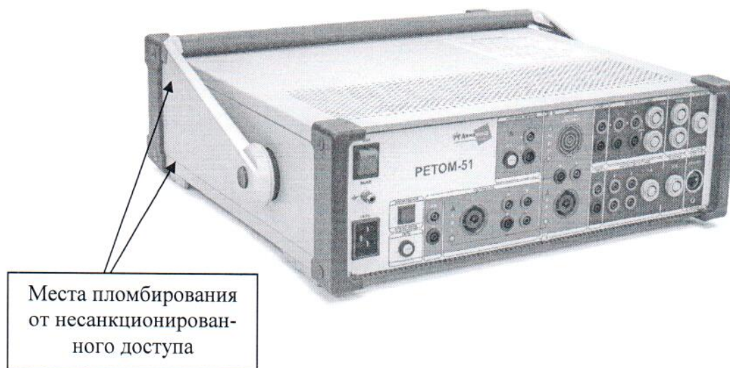
Рисунок 1 – Общий вид устройства РЕТОМ™-51 и места пломбирования от несанкционированного доступа
