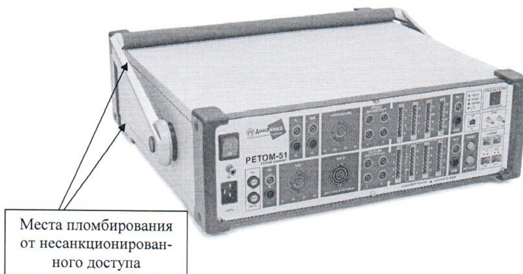
Рисунок 2 – Общий вид устройства РЕТОМ™-51.1 и места пломбирования от несанкционированного доступа
