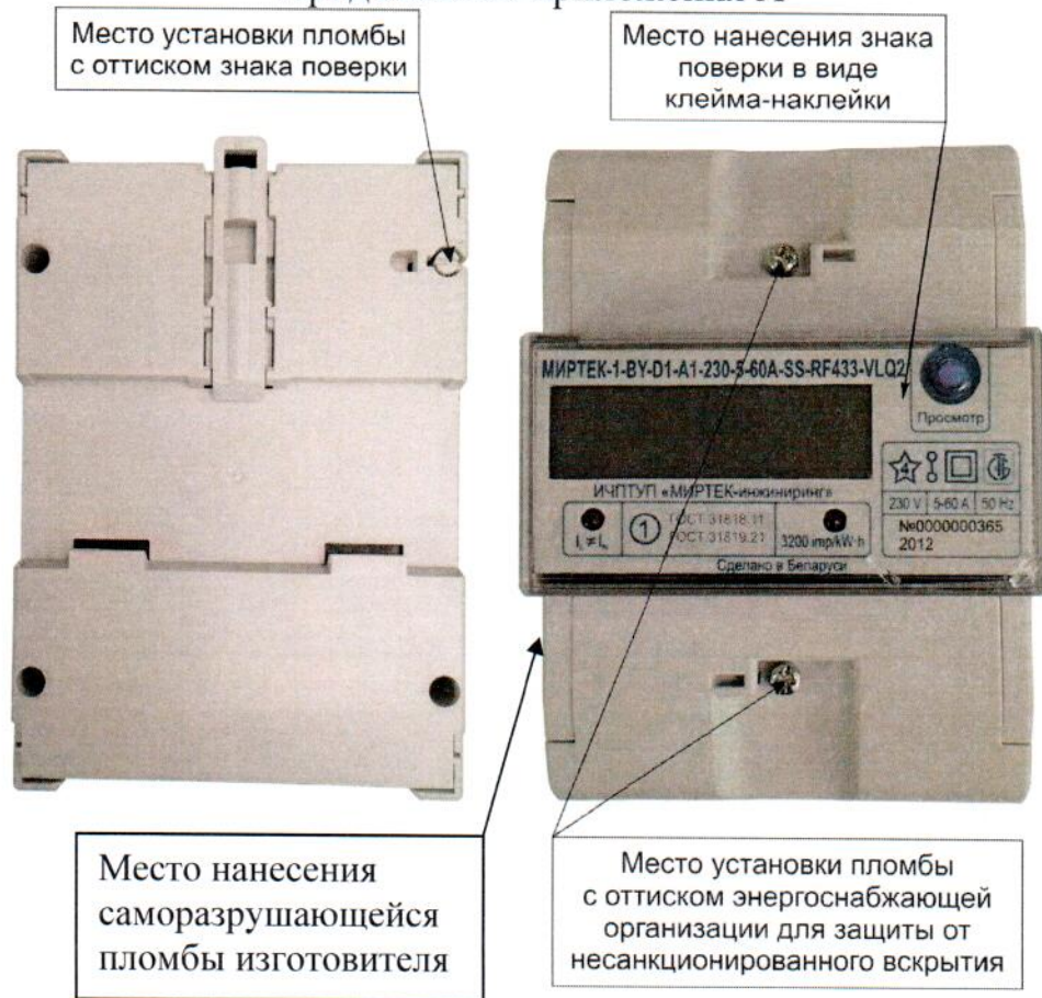
Рисунок А.3 – Места установки пломб и нанесения знака поверки для счетчиков в корпусе D1
