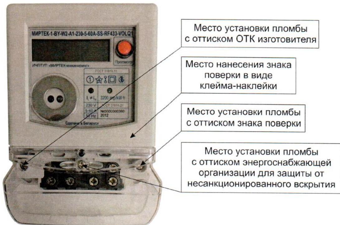
Рисунок А.2 – Места установки пломб и нанесения знака поверки для счетчиков в корпусе W2
