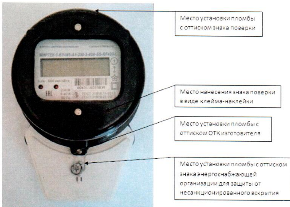
Рисунок А.4 – Места установки пломб и нанесения знака поверки для счетчиков в корпусе W5
