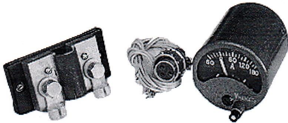
Рисунок 1 - Общий вид вольтамперметра ВА-040
