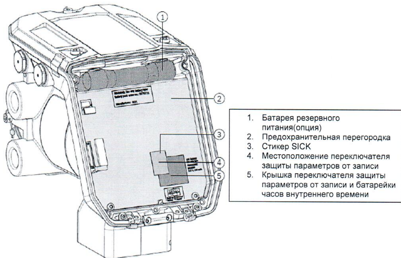
Рисунок А.3 – Место расположения и пломбировка переключателя защиты параметров счетчика FLOWSIC600 от записи
