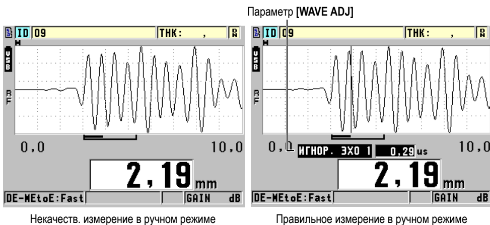
Рис. 6-5 Сравнение измерений в ручном режиме
