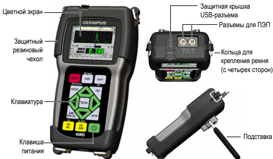
Рис. 1-1 Компоненты приборной части 45MG — Вид спереди, сверху и сбоку
