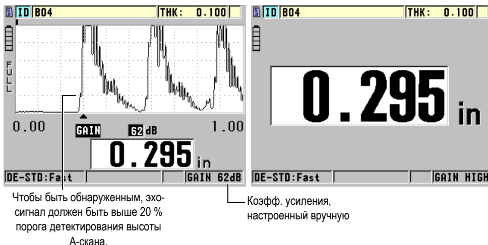
Рис. 9-1 Настройка усиления вручную
