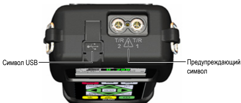
Рис. i-1 Расположение символов на верхней панели 45MG
