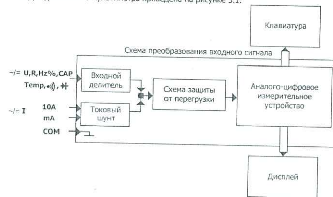
Рис. 5.1 – Структурная схема мультиметра
