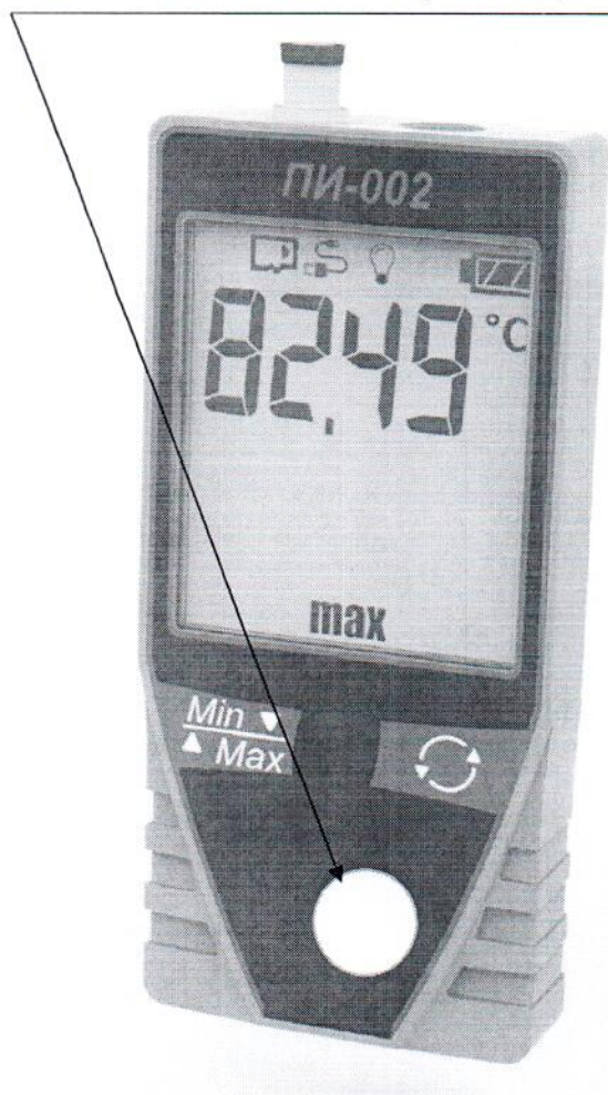
Рисунок А.2 Внешний вид приборов измерительных ПИ-002/3М, ПИ-002/4М место нанесения знака Утверждения типа и знака поверки в виде клейма-наклейки.
