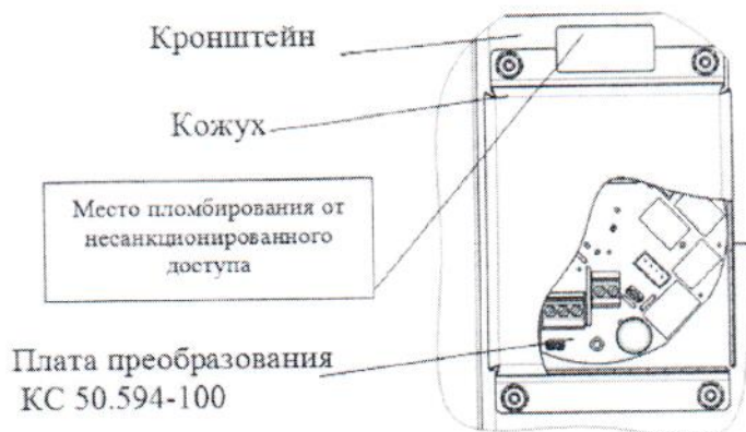
Рисунок 1 - Общий вид анализатора «ГигроСкан-С» КС 50.591-000 и схема пломбировки от несанкционированного доступа
