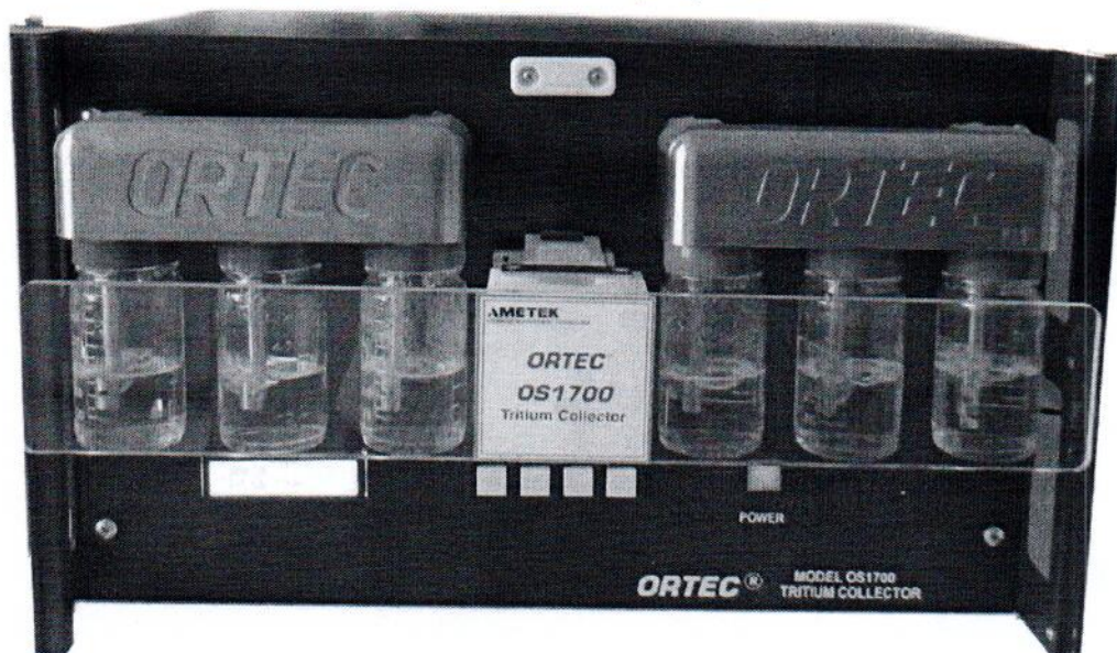
Рис. 1 – Расходомер-коллектор трития и углерода OS-Bubbler ORTEC модель OS1700
