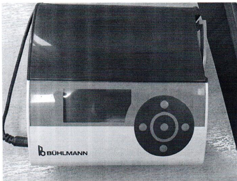
Рисунок 1 – Ридер (анализатор) для экспресс-определения кальпротектина Quantum Blue Reader
