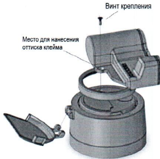
Рисунок 3А. Схема пломбировки EDC-модуля от несанкционированного доступа с указанием места для нанесения отпечатка клейма
