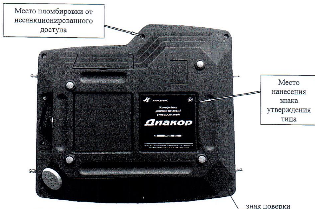
Рисунок 2 – Схема пломбировки от несанкционированного доступа, места нанесения знаков утверждения типа и поверки
