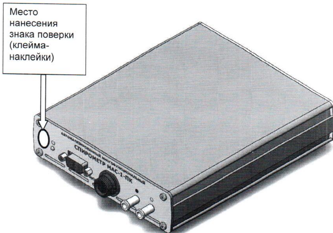
Рисунок А.3 – Схема нанесения знака поверки прибора МАС-1-ПК
