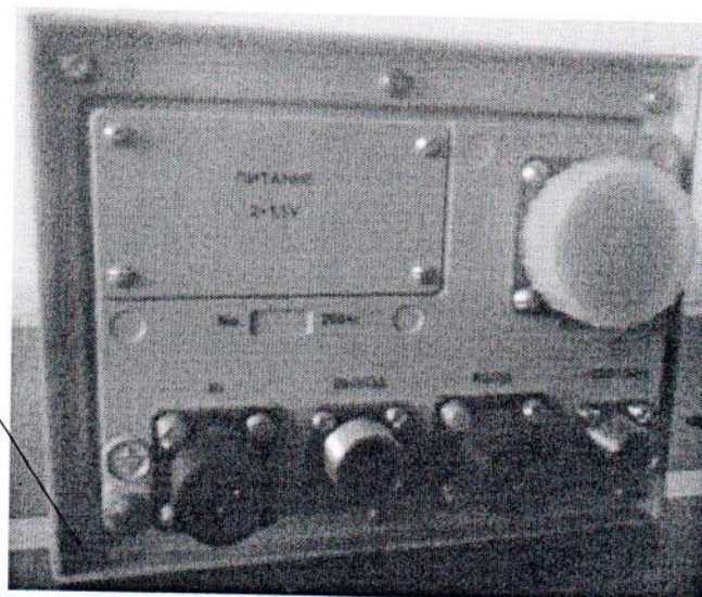
Рисунок А.2 – Схема опломбирования преобразователей от несанкционированного доступа
