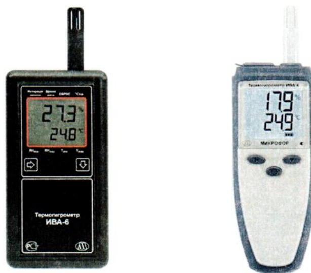
Рисунок 1 - Общий вид термогигрометров ИВА-6Н
