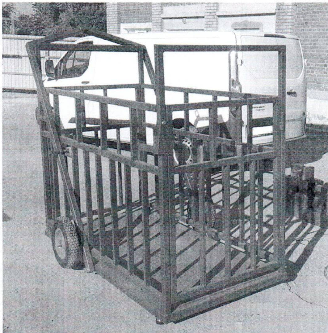
Рисунок 1 – Общий вид грузоприемного устройства весов для взвешивания животных
